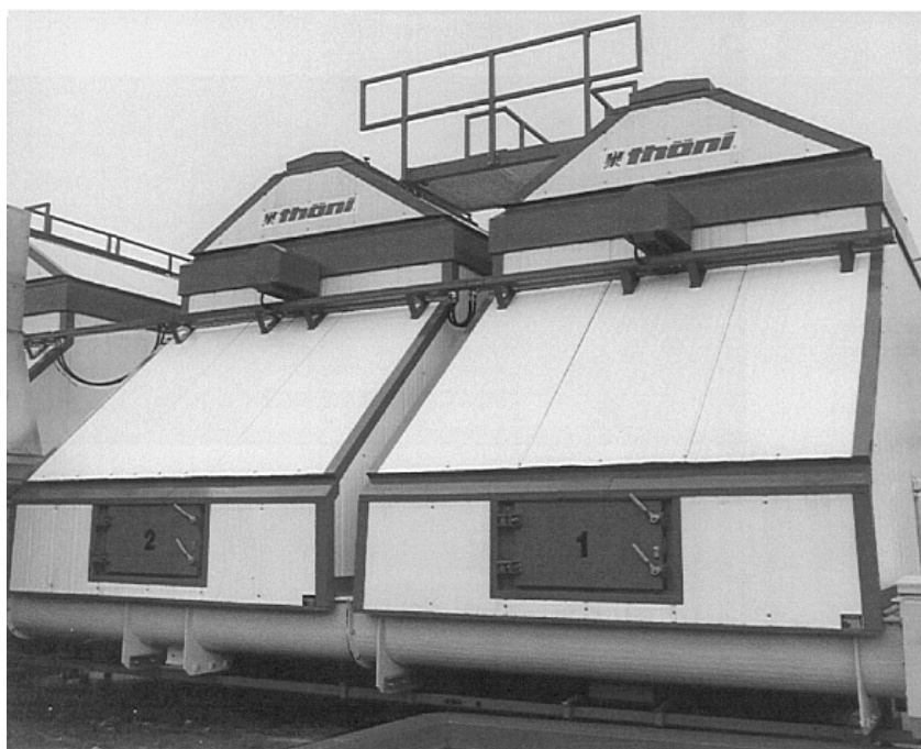
Figura 6 – Biocelle dinamiche Thöni TDM (Documentazione tecnica Ecotec System - Thöni)
